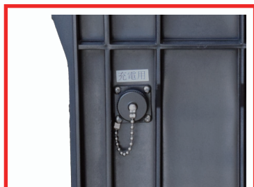
側面にある充電器ソケットにケーブルを差し込みます。
