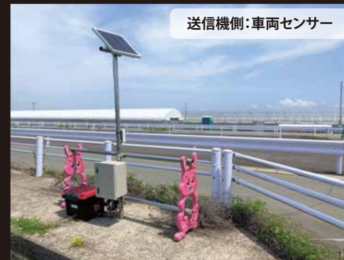
② 警報装置が作動 車両センサーの場合
