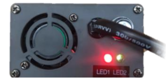
LED1ランプ赤点灯LED2ランプ緑点灯時...充電完了
